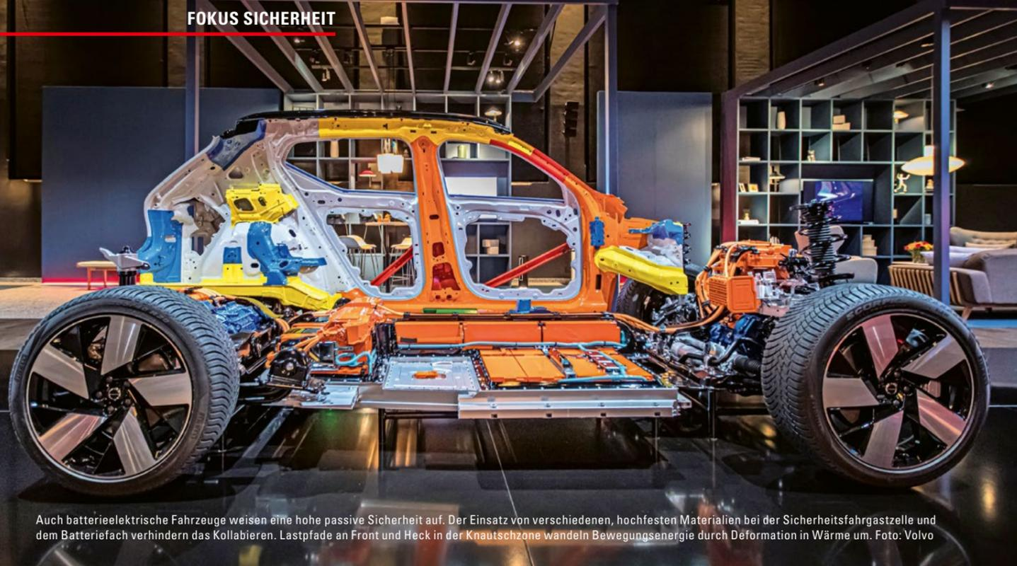
Auch batterieelektrische Fahrzeuge weisen eine hohe passive Sicherheit auf. Der Einsatz von verschiedenen, hochfesten Materialien bei der Sicherheitsfahrergastzelle und dem Batteriefach verhindern das Kollabieren. Lastpfade an Front und Heck in der Knautschzone wandeln Bewegungsenergie durch Deformation in Wärme um. Foto: Volvo
