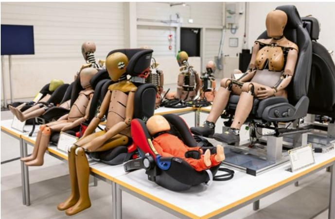
Die Dummy-Familie erlaubt die Aufnahme von unzähligen Parametern während des Crashes und die Optimierung von Rückhaltesystemen von Klein bis Gross. Foto: Audi
