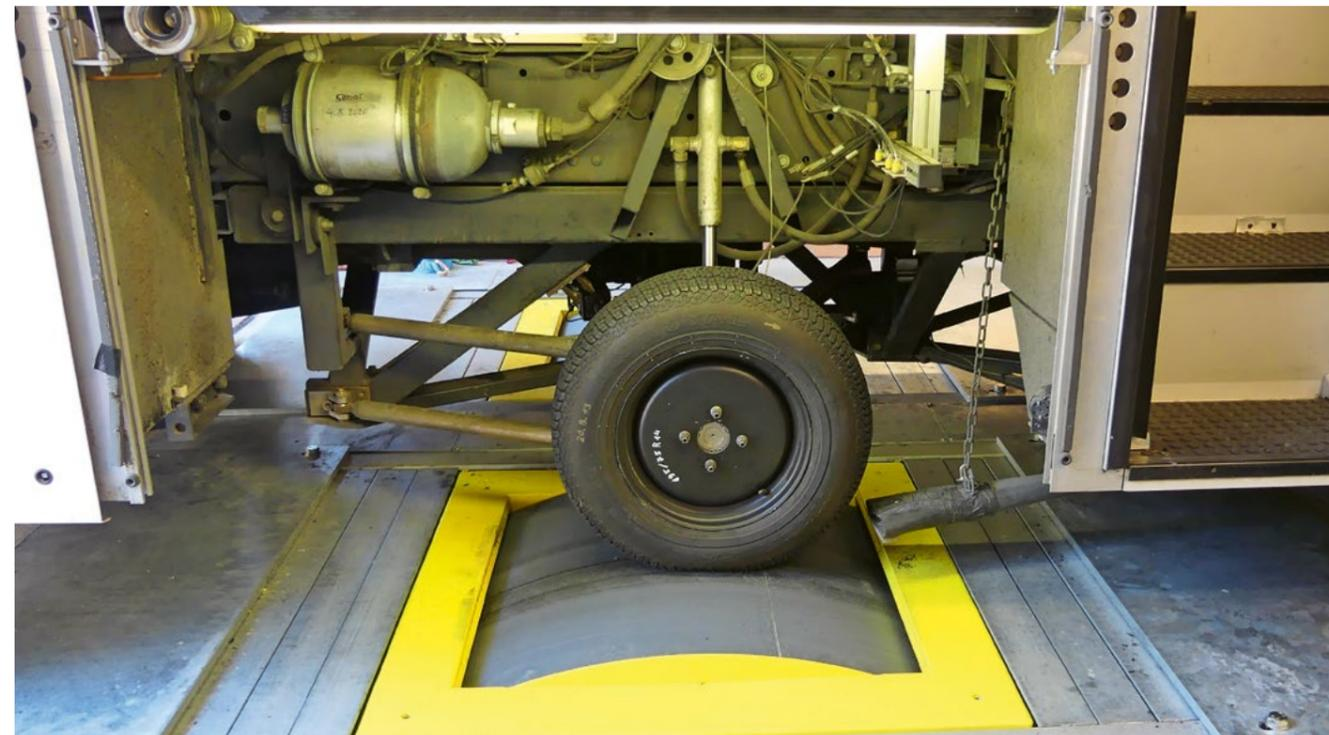
Die Berner Fachhochschule untersuchte Reifen und deren Abrieb zuerst auf dem Rollenprüfstand und danach auf der Strasse mit dem fahrenden Reifenlabor. Foto: BFH
