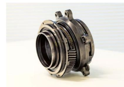
Mittels Elektromotor kann über die Verzahnung des Lamborghini-Prototyps die Radnabenstellung für variable Sturzwerte erfolgen. Foto: Lamborghini
