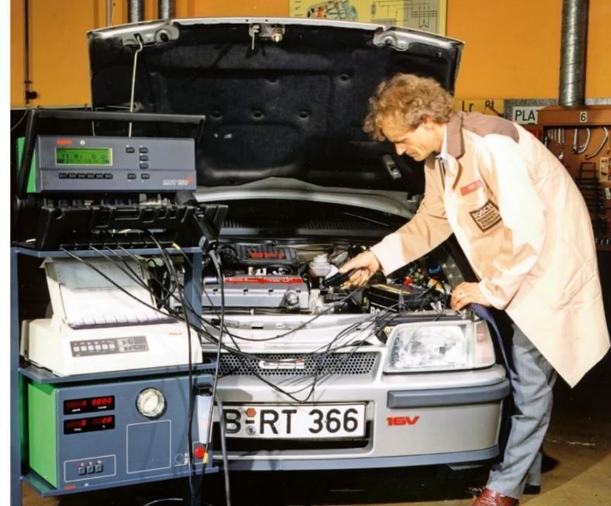
Avant de contrôler ou de régler le ralenti ou le mélange, il faut toujours commencer par vérifier le système d'allumage. Un appareil de mesure du CO (sur le chariot ci-dessous) mesure la teneur en monoxyde de carbone. Photo : Robert Bosch GmbH, archives
