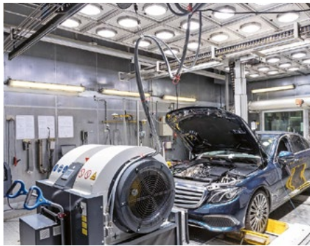
Les équipementiers et les constructeurs automobiles utilisent des systèmes de mesure des gaz d'échappement qui coûtent des millions pour effectuer des mesures précises et reproductibles sur banc d'essai (à gauche) ou sur route (à droite). Photo : Mercedes
