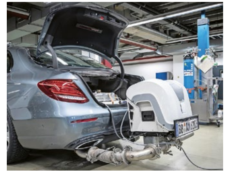
Les équipementiers et les constructeurs automobiles utilisent des systèmes de mesure des gaz d'échappement qui coûtent des millions pour effectuer des mesures précises et reproductibles sur banc d'essai (à gauche) ou sur route (à droite). Photo : Mercedes
