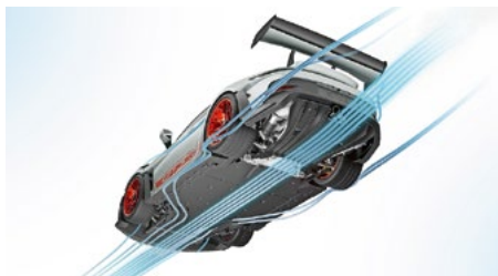
Il est certes possible d'obtenir des forces down-force avec des ailerons arrière martiaux. Un diffuseur sur l'essieu arrière assure la force de pression à haute vitesse et donc une grande stabilité du véhicule. Photo: Porsche
