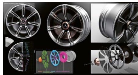
Des roues entièrement carénées avec écrous centraux ont été transférées de la course automobile au concept-car Mercedes-Benz EQXX. L'aérodynamisme et donc la résistance à l'air diminuent ainsi sensiblement. Photo: Mercedes
