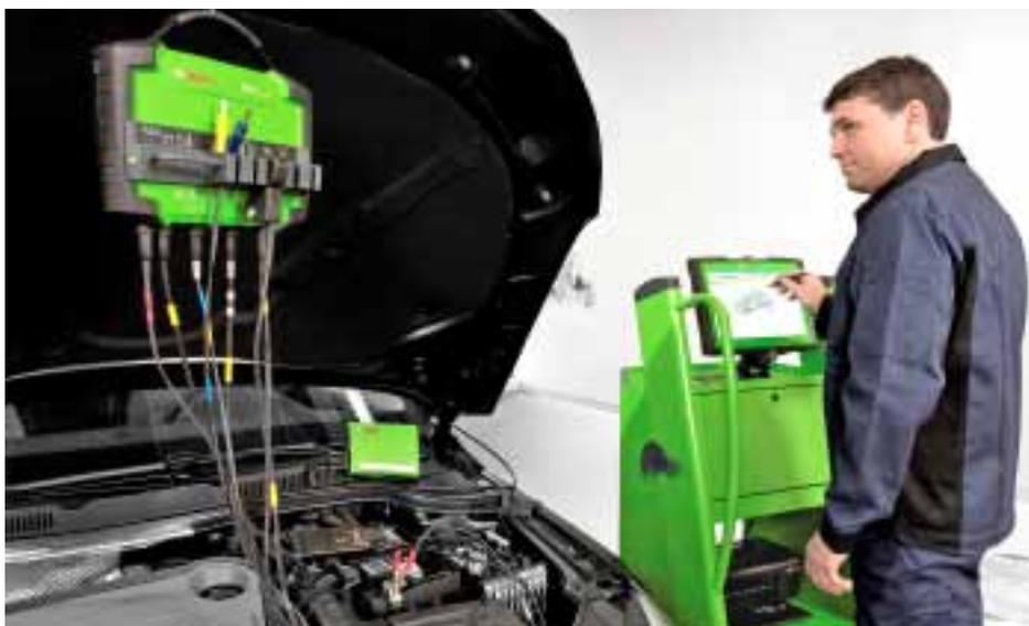
L'ordinateur est devenu incontournable pour les travaux de mesure et de diagnostic.
