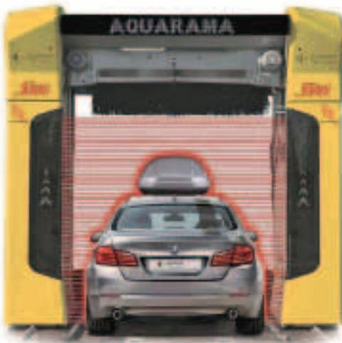
Les pick-ups, coffres à skis et structures de toit spéciales comme sur les véhicules de police et de secours, sont enregistrés.
